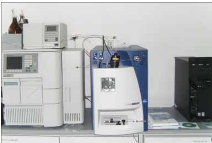
Rycina 1. Tandemowy spektrometr mas Quattro Micro™ API firmy Micromass połączony z zestawem HPLC firmy Waters (LC-MS-MS)
