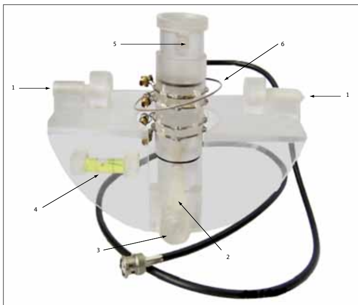
Rycina 4. Komora przepływowa zintegrowana z sondą pomiarową; 1 – śruby do pozycjonowania komory przepływowej w magnecie, 2 – wlot cieczy, 3 – śruba pozycjonująca cewkę RF w komorze przepływowej, 4 – poziomica, 5 – wylot cieczy, 6 – ruchoma cewka sprzęgająca
